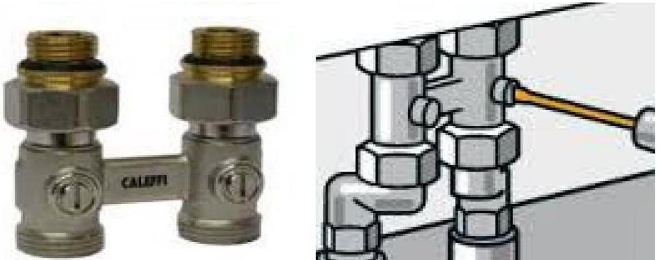
Der Schlitz in den Schrauben soll, wie oben zu sehen, parallel zur Fließrichtung sein. Dann sind die Leitungen geöffnet. Wenn dagegen ein oder beide Schlitz quer zur Fließrichtung sind, dann kann kein Heizungswasser fließen. Die Schrauben mit einem Schraubenzieher um 90° nach links drehen. Dann sollte der Heizkörper gehen.
