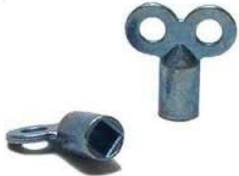
Man öffnet mit einem Schlüssel die Vierkant-Entlüftungsschraube. Manchmal hat der Vierkant auch einen Schlitz, dann reicht auch ein Schraubenzieher. Zuvor die Auslauföffnung nach unten drehen (das kleine weiße Teil lässt sich drehen). Normalerweise hört man anfangs Luft, solange bis Wasser kommt. Dann **sofort** zudrehen (Es macht technisch gesehen kein Sinn, Wasser ablaufen zu lassen!).
